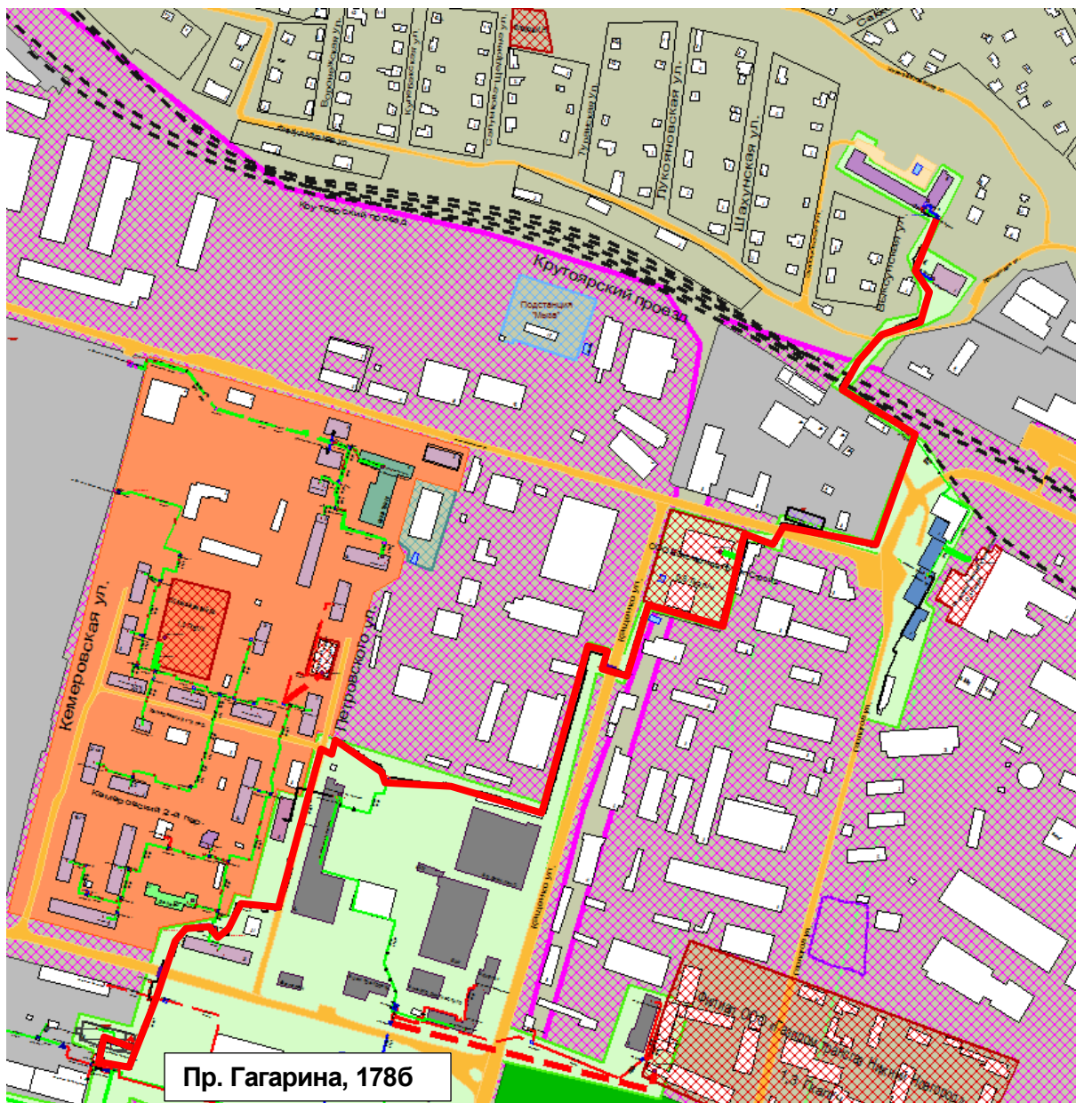
Рисунок 1.63 – Результат гидравлического расчета - расчетный путь теплоносителя от котельной пр. Гагарина, 1786 до ЦТП-706
