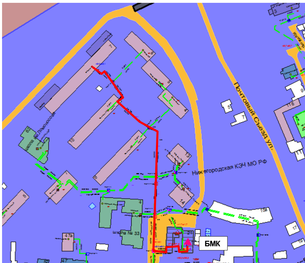
Рисунок 1.11 – Результат гидравлического расчета - расчетный путь теплоносителя от котельной Суетинская, 21 до ПТ-Федор,7
