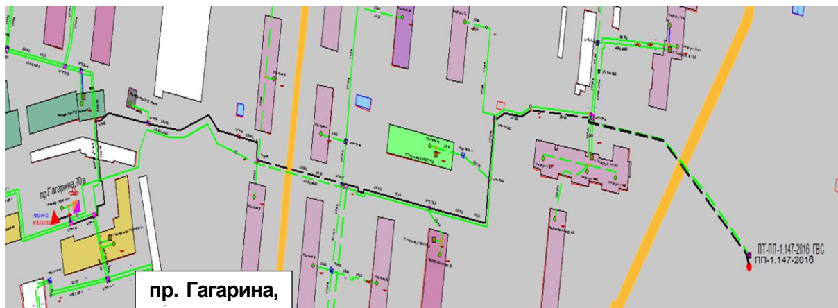
Рисунок 1.53 – Результат гидравлического расчета - расчетный путь теплоносителя от котельной пр. Гагарина, 70а до ПТ- ПП-1.147-2016
