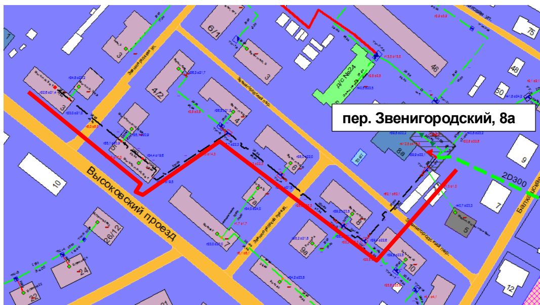
Рисунок 1.47 – Результат гидравлического расчета - расчетный путь теплоносителя от котельной пер. Звенигородский, 8а до ПТ-Выс.пр,3 в1
