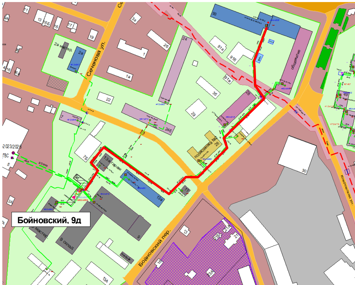
Рисунок 1.23 – Результат гидравлического расчета - расчетный путь теплоносителя от Бойновский, 9д до ПТ-Б.Печер, 93 МВД
